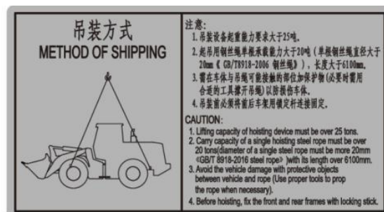
错误! 未找到引用源。44 Схема подъема целой машины
