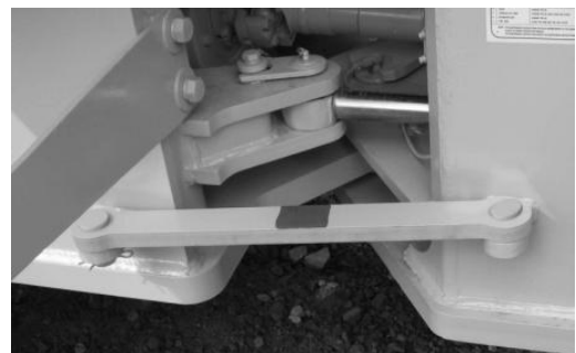
错误! 未找到引用源。43 Схема рычага блокировки поворота рамы в заблокированном положении
