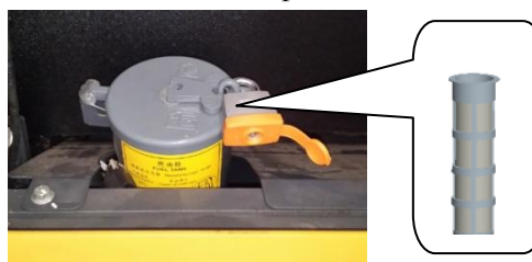
Рис. 3-4 Сливной фланец топливного бака
