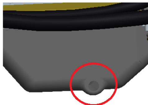
Рис.3-17 Спускное отверстие моторного масла
