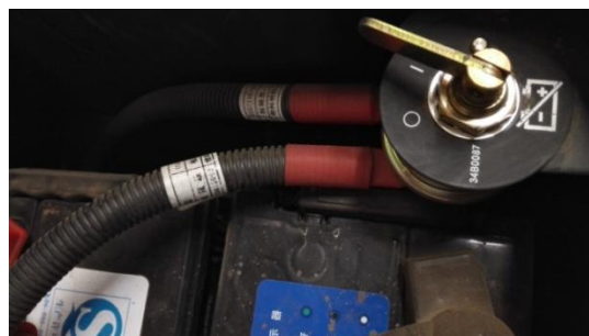
Рис. 2-19 Выключатель аккумуляторов
